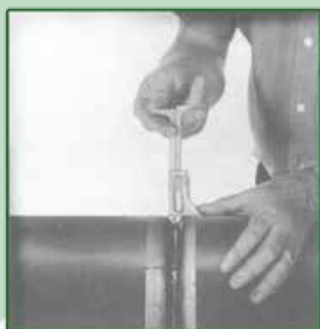
Disallineamento interno della parete del tubo
