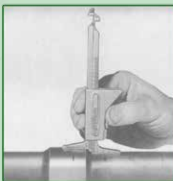
Altezza del raccordo saldato
